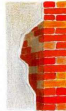
Mur ancien en briques enduit au plâtre ou chaux
