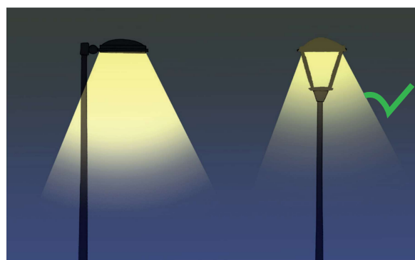
Exemple schématique de mobilier d'éclairage récent éclairant par LED. Ce type de source lumineuse très peu encombrante associée à la géométrie du mobilier permet un flux lumineux quasi exclusivement orienté vers le bas et réduisant ainsi substantiellement la pollution lumineuse.
