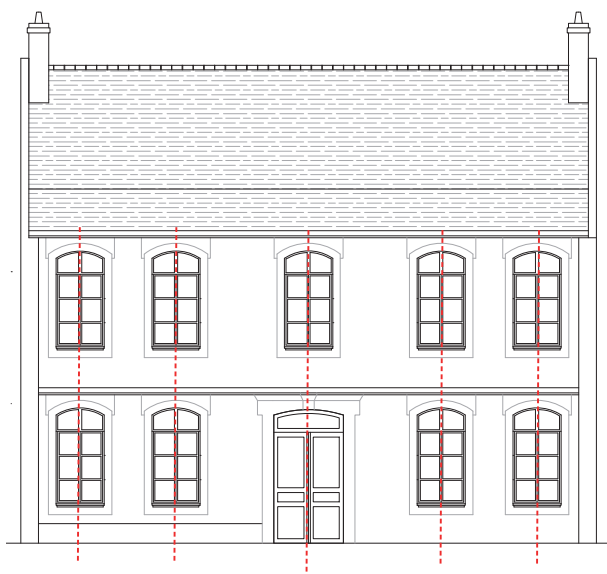
Façade ordonnancée à cinq travées
